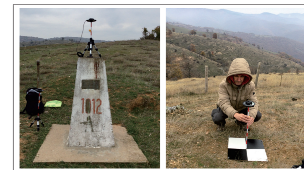
図4 AAS Loggerを用いたRTK-GNSS測量の実施
