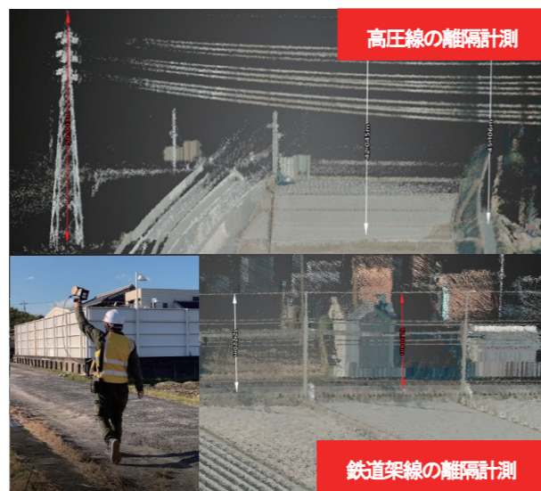
図3 手持ち型レーザスキャナによる離隔計測
