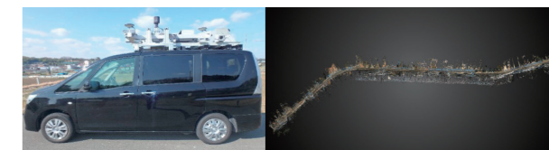
図7 MMS計測車両と取得した三次元点群データ
