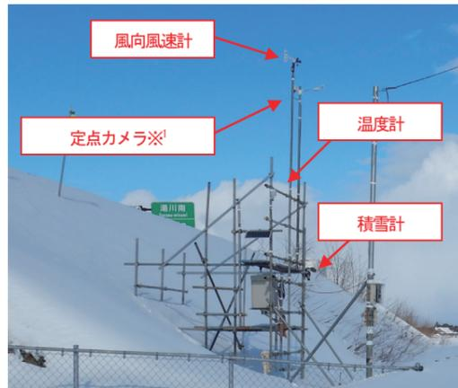
図1 定点気象観測計および気象観測項目
