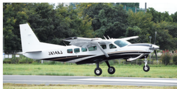
セスナ式208型（登録番号:JA14AJ） 高翼ターボプロップ単発機。キャビン容量が広く、大型機材でも十分搭載可能。
