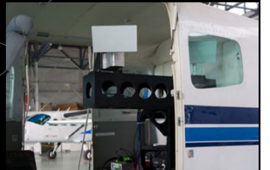
ATSARの取付状況
