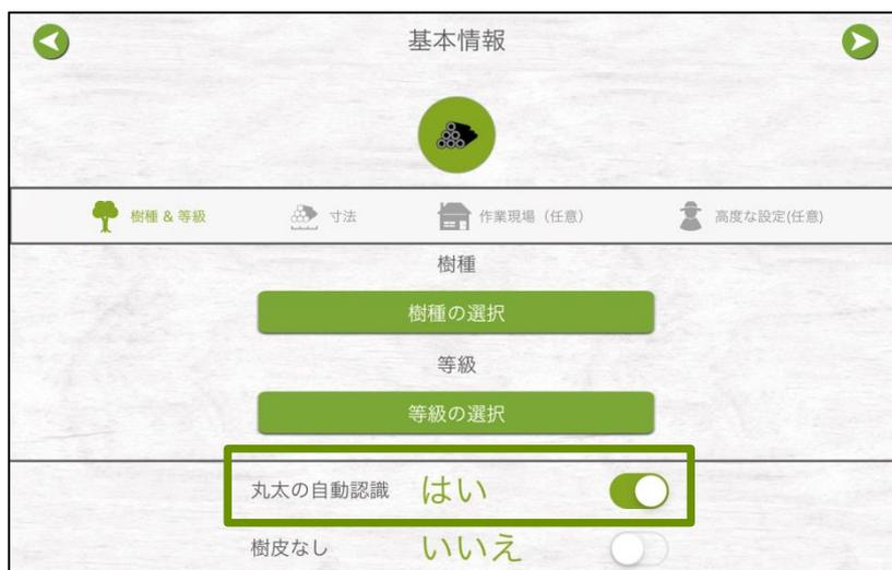
図 27 丸太の自動認識の選択=はい
