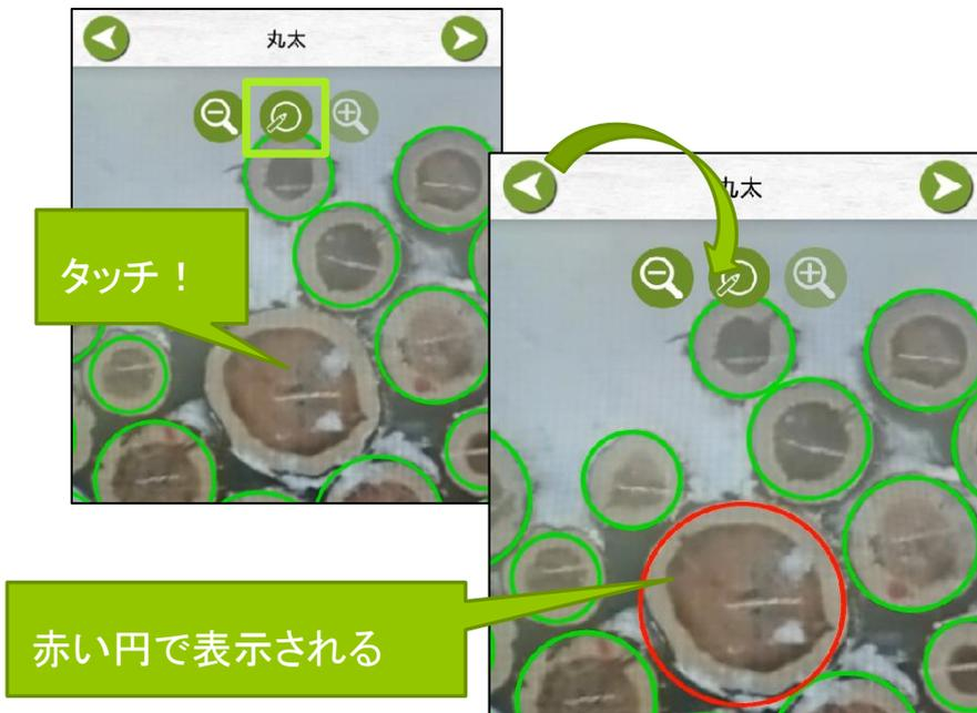
図 67 認識されなかった丸太の修正
