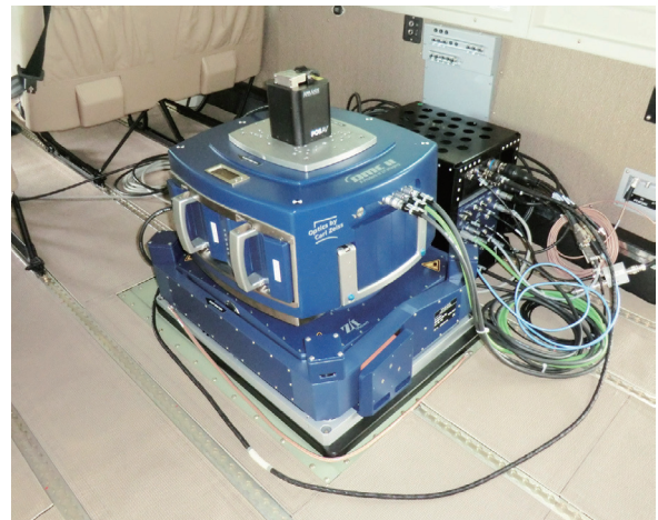
図1 航空機に搭載したDMCII230本体
