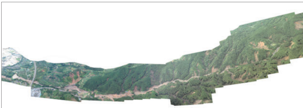
図1 オブリーク航空カメラ（PDC）の斜方視画像を連続的に合成した斜めモザイクの例（奈良ヶ谷川）
