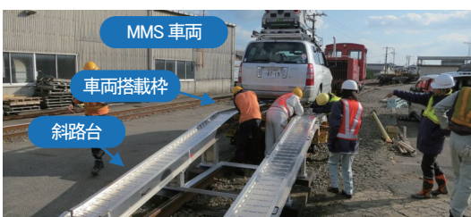
図2 MMS車両の搭載方法
