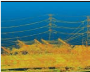
送電線・鉄塔の点群鳥瞰図
