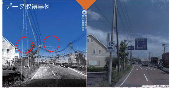
従来の路面性状車 (90°) よりも 60° のレーザスキャナのほうが道路施設の計測能力が高い
