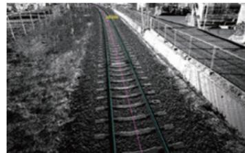
RaiLis®によるレーザ点群と設備 自動抽出
