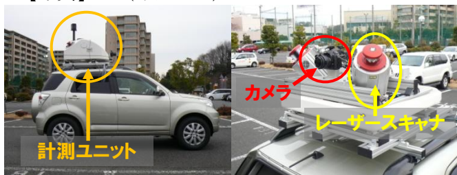
車両への取付状況
