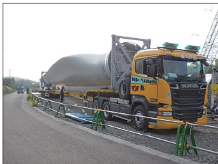
図1 特殊大型トレーラーによる輸送状況
