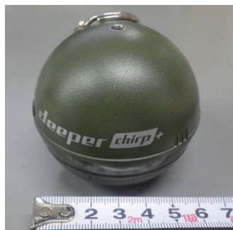
図2 GPS内蔵小型測深機 (Deeper)
