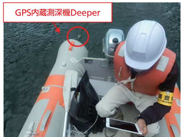
図3 船舶でDeeperを牽引し測深を実施
