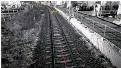
RaiLisによるレーザ点群と設備自動抽出
