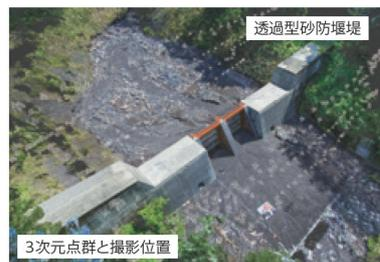
Visual SLAM搭載UAVによる詳細点検
