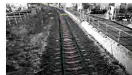
Railisによるレーザ点群と設備自動抽出
