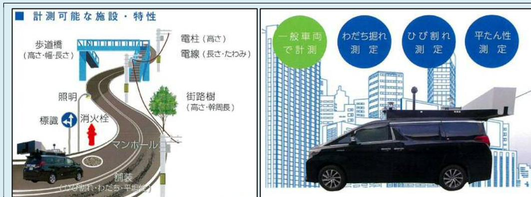
図8 MMS計測のイメージ
