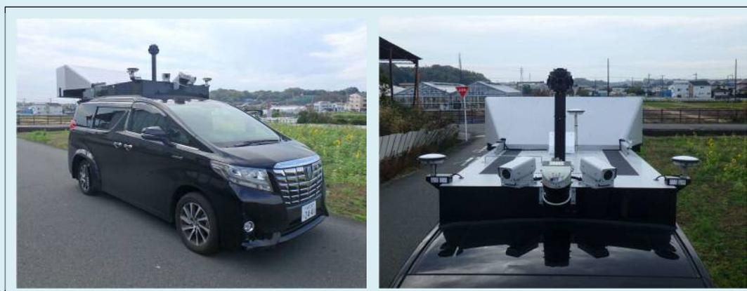
図9 MMS 5号機(左：車両全体写真 右：搭載している計測機器部分)
