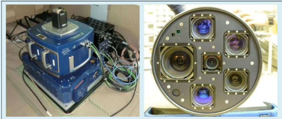
図 1 DMC II 航空測量カメラ
