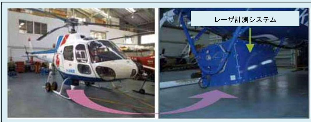
図5 ヘリコプターに搭載したレーザ計測システム
