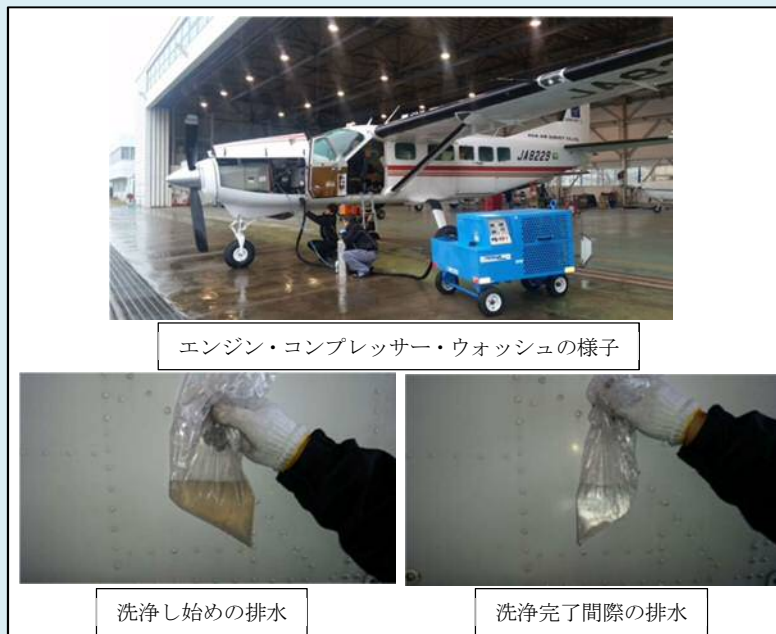
図 2.1.26 エンジン・コンプレッサーの洗浄作業
