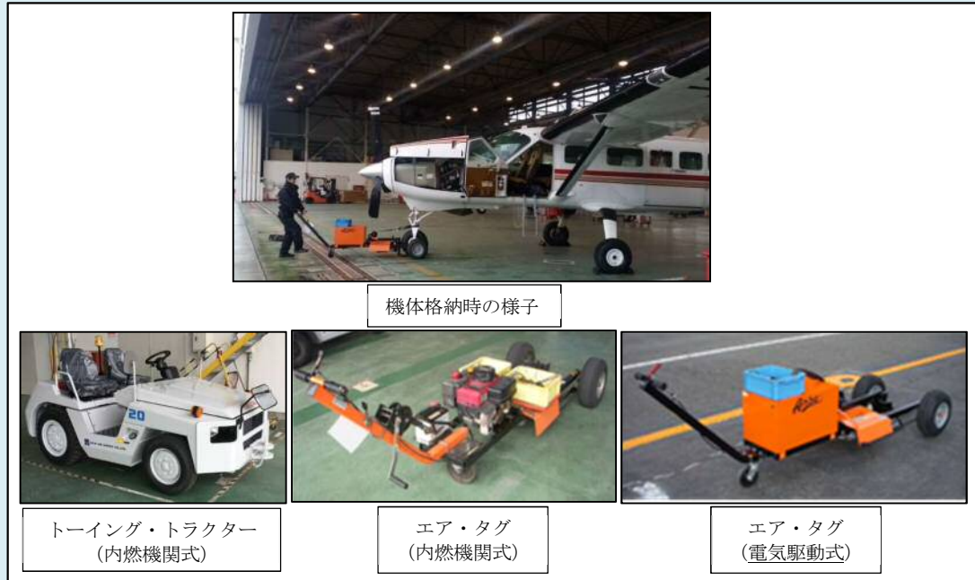
図 2.1.25 牽引車を使った作業
