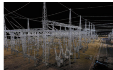
変電所計測データ(地上レーザ)
