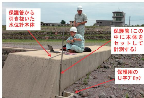
図3 簡易水位計データ回収状況
