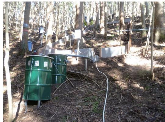
図7 土砂と水の流れを把握する観測装置
