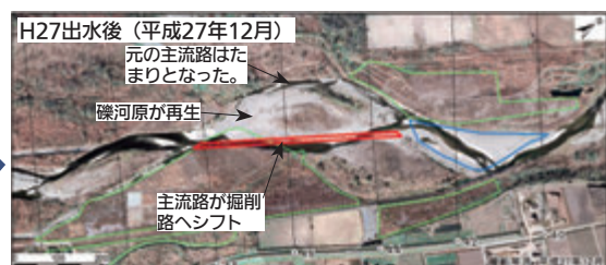
図4 平成25年度工事後と平成27年9月台風18号後の河道状況
