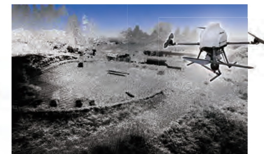
UAVによる3次元計測(点群データ)
